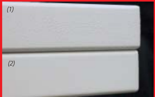
(1) geschliffen und grundiert / sanded and primed (2) geglättet und grundiert / smoothed and primed
